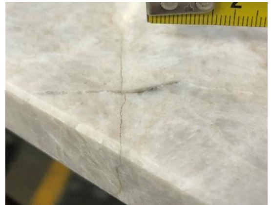
Her ses en mindre glasåre, som visuelt kan forveksles med en revne.
