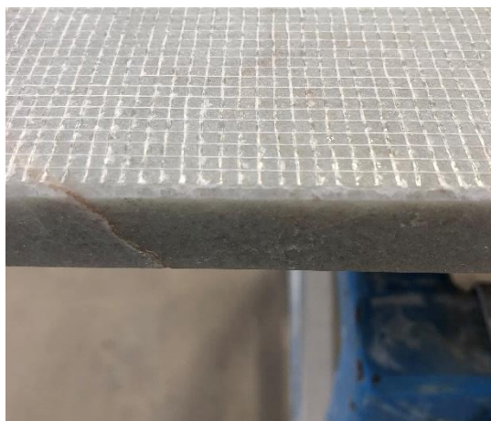
Här syns undersidan av en skiva där nätet går ända ut i kanten
