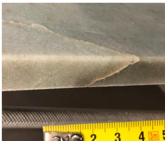
Här syns en ådra som kan misstas för att vara en spricka.
