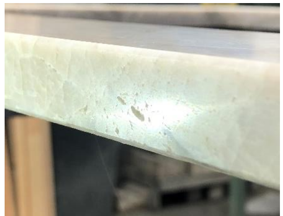
På polerede forkanter forekommer der ofte små fordybninger i materialet. Disse kan også mærkes.
