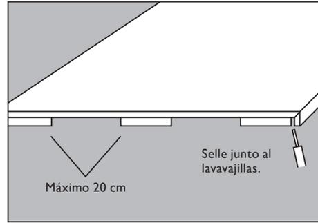
Colocar los listones de apoyo que se incluyen con el producto a lo largo de la encimera. Dejar una distancia máxima de 20 cm entre los listones. Junto al lavavajillas, juntee entre el canto delantero y el listón de apoyo para el sellado del núcleo del tablero de conglomerado.
