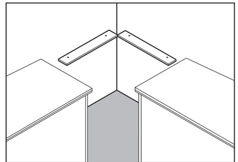
Cuando se trate de encimeras de esquina, es importante que estén SIEMPRE apoyadas y fijadas en los armarios. Si no hay armarios, la encimera DEBE apoyarse y fijarse en los listones de la pared.
