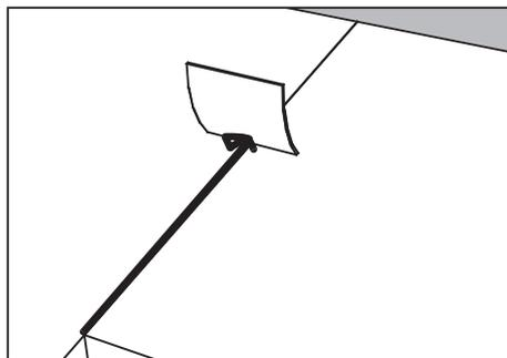
Espere unos 5 minutos y retire el material de sellado sobrante, p. ej. con una lámina de plástico, siempre desde el canto trasero hacia el canto frontal. Arrastre siempre la lámina hacia usted, de forma que el material sobrante penetre en lugar de sobresalir.
