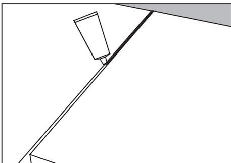
Una provisionalmente las juntas y ajústelas, de forma que la encimera y los cantos estén nivelados antes de aplicar el material de sellado. Puede recubrirse la encimera de cinta adhesiva para evitar restos de material de sellado sobre la encimera.
