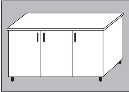
Si los armarios bajos no se apoyan en un zócalo fijo sino que solamente se sujetan a la pared, se recomienda apoyarlos sobre patas. Esto impide que los armarios cedan con el tiempo por el peso de la encimera y pierdan el nivelado.
