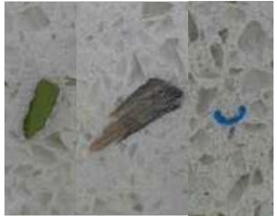
Her sees eksempler på glass, tre og plast som ikke er tillatt i overflaten
