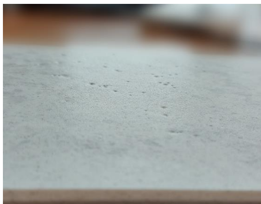
Eksempel på en konsentrasjon av knappenålshull som ikke er akseptert, og som er reklamasjonsberettiget
