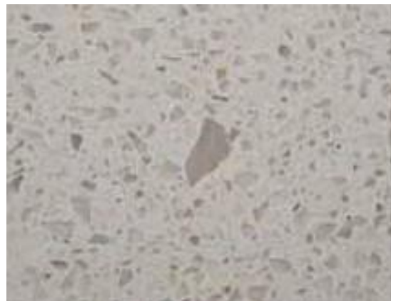
Eksempel på kvartskorn som overstiger den maksimale størrelsen
