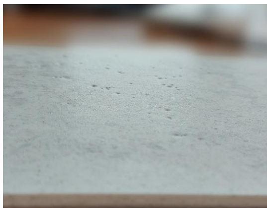
Eksempel på en koncentration af pinholes som ikke er accepteret og er reklamationsberettiget
