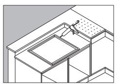
Beim Einfügen/bei der Montage von flachintegrierten Kochplatten muss die Kochplatte rundum verfugt werden. Stellen Sie sicher, dass genügend Fugenmasse vorhanden ist, damit die Fuge rundherum gleichmäßig geglättet werden kann. Die Fugenmasse kann zusammen mit der Kochplatte bestellt werden. Bei flach verleimten Kochplatten muss die Kochplatte durch Klötze unterstützt werden, bis sie knapp unter der Arbeitsplattenebene liegt.
