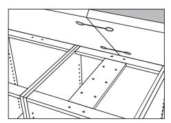
Bei der Plattenmontage auf Elementen ohne Oberseite muss die gesamte Länge der Fuge mit einer flachen Platte (z. B. Spanplatte/Sperrholz oder dergleichen) abgestützt werden.
