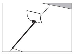
Nach ca. 5 Min. wird das überschüssige Dichtungsmaterial mit einem Stück Pappe entfernt. Immer von hinten nach vorne. Die Pappe wird immer in Richtung des Montierenden gezogen, so dass das Dichtungsmaterial nicht nach oben, sondern nach unten gedrückt wird. Eventuelle Reste des Dichtungsmaterials können mit Seifenwasser entfernt werden.
