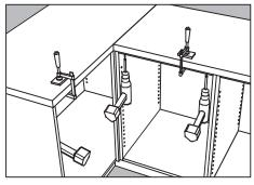
Befestigen Sie die Arbeitsplatte mithilfe der vorgebohrten Schraubenlöcher an den Küchenelementen. Die Arbeitsplatte kann während der Befestigung ggf. durch Schraubzwingen an Ort und Stelle gehalten werden. Denken Sie jedoch an Schutzblöcke, um eine Beschädigung der Oberfläche zu vermeiden.
