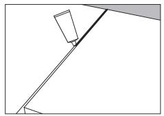
Das Dichtungsmaterial, bei dem es sich um die beiliegende Schmalfugenmasse (kein Silikon/Holzleim) handeln muss, wird dann in die Fuge eingefüllt, so dass man eine optimale Abdichtung erhält. In Bezug auf das Eindringen von Wasser in die Fugen wird keine Garantie übernommen. Dann werden die Platten ganz zusammengeschoben.
