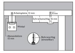
Das mitgelieferte Servicepaket für die Kompaktlaminatplatte enthält die erforderlichen Schrauben und Winkel sowie einen 3 mm Bohrer mit einstellbarem Anschlag. Bohren Sie 8 mm in die Arbeitsplatte hinein.
