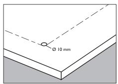
Generell ist es bei allen Ausschnitten wichtig, dass alle Ecken mit einem 10 mm Bohrer vorgebohrt werden, damit scharfe Ecken vermieden werden, da diese Risse verursachen können.
