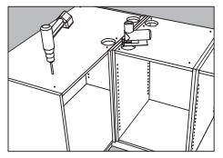
Falls die Schränke Oberseiten haben, müssen oben Löcher geschnitten werden, damit eventuelle Arbeitsplattenverbindungen mit Spannbeschlägen aus dem Schrankinneren heraus vorgenommen werden können. Zur Befestigung der Arbeitsplatte wird ein 3 mm Loch durch die Schrankoberseite an der Vorderseite, in der Mitte und auf der Rückseite alle 300 mm gebohrt. In Längsrichtung an Vorder- und Rückseite alle 600 mm. Die Platten müssen alle 600 mm abgestützt werden.
