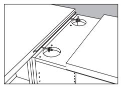
Bei Verbindungen wird die mitgelieferte Feder in der Länge angepasst, bevor sie im Nutgang montiert wird. Die Platten werden nicht vollständig zusammengeschoben, und die Verbindungsbeschläge werden montiert.
