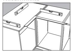
Überprüfen Sie vor der Montage mithilfe einer Wasserwaage, dass die eingebauten Küchenelemente waagerecht und im Winkel zueinander angeordnet sind.
