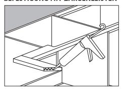
Die Verbindungen müssen verfugt werden. An sichtbaren Zargenstücke wird eine Vorderkante angebracht und an die individuelle Arbeitsplatte angepasst.
