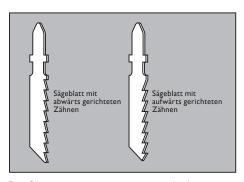
Das Sägen von vorne mit einem nach oben gerichteten Sägeblatt kann zu Oberflächenkratzern führen.
