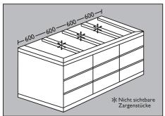
Nicht sichtbare Zargenstücke haben keine Vorderkante und müssen vom Monteur in der Länge angepasst werden. Der Maximalabstand zwischen diesen beträgt 600 mm.
