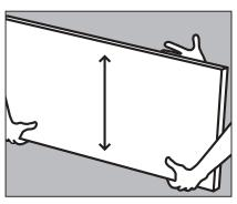
Unter keinen Umständen sollte ein Ausschnittloch oder ein Bohrloch als »Griff« verwendet werden.
