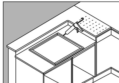
Pour fixer le plan de travail, percez des trous de 6 mm par le dessus du placard dans les bords avant et arrière. Le plan doit être fixé au moins tous les 600 mm sur la longueur.
