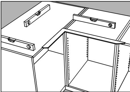
Avant le montage, vérifiez avec un niveau que les éléments de cuisine montés sont installés à l'horizontale et à angle droit, les uns par rapport aux autres. La moindre différence de niveau peut rendre l'assemblage difficile. Il est possible de rectifier le niveau avec une mince feuille de placage ou matériau similaire.
