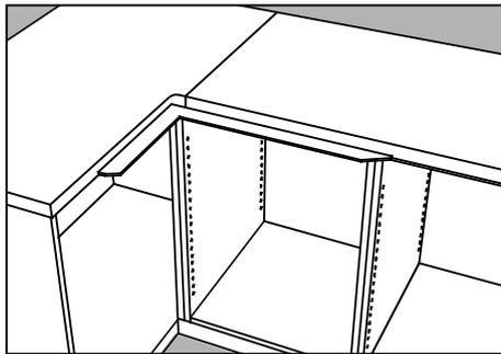
Posez le set de plans de travail sur les éléments de cuisine pour vérifier si les mesures et les angles sont exacts. Retirez-les ensuite des éléments. Si le plan de travail ne correspond pas, contactez immédiatement votre détaillant. Remarque: Tous les angles sont de 90° à la production, sauf mention spéciale à la commande.
