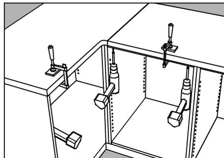
Fije la encimera a los módulos de cocina utilizando los agujeros previamente perforados. La encimera puede sujetarse con mordazas durante el montaje; en ese caso, utilice protectores para evitar dañar la superficie.
