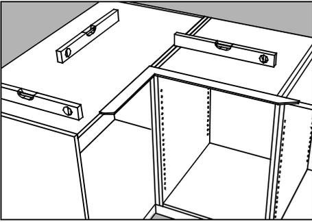
Antes de comenzar el montaje, debe comprobarse con ayuda de un nivel que los módulos de la cocina ya instalados estén nivelados y en ángulo entre ellos. Si existen pequeñas diferencias de nivel, puede resultar complicado conseguir que las juntas coincidan. Esto puede corregirse con una pieza fina de chapa u otro material similar.
