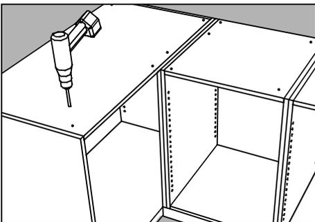
Para fijar la encimera, perfora un orificio de 6 mm en los cantos frontal y trasero que atraviese la cubierta de los armarios. La encimera debe fijarse cada 600 mm como mínimo en sentido longitudinal.
