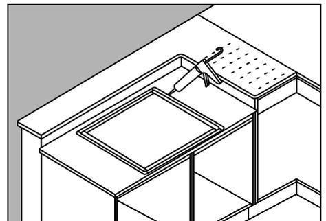
Para la colocación/montaje de placas de cocción integradas a ras, debe sellarse todo el contorno de la placa. Procure que haya masilla de sellado suficiente para que la junta pueda pulirse de forma homogénea todo alrededor. La masilla de sellado puede encargarse junto con la encimera.
