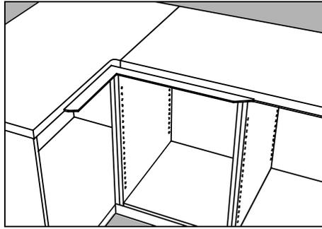
Coloque la encimera suelta sobre los módulos de la cocina para comprobar que las medidas y los ángulos sean correctos. A continuación, vuelva a retirarla de los módulos. Si la encimera no encaja, póngase en contacto con el distribuidor correspondiente. Nota: Todos los ángulos son de 90 grados, a menos que se solicite otra medida.
