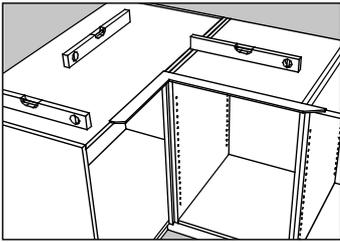
Avant le montage, contrôler à l'aide d'un niveau que les éléments de la cuisine installés sont montés horizontalement et perpendiculairement les uns par rapport aux autres. S'il y a la moindre différence de niveau, il peut être difficile d'obtenir un assemblage correct. Le problème peut être résolu en utilisant un mince morceau de contreplaqué approprié ou un matériau similaire.
