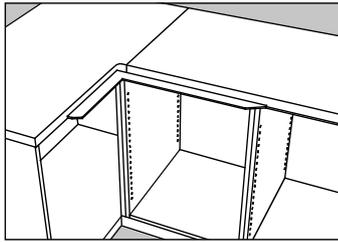
Poser le plan de travail sans le fixer sur les éléments de cuisine, pour contrôler que les dimensions et les angles sont exacts. Retirer ensuite le plan de travail des éléments de cuisine. Si le plan de travail n'est pas adapté, prendre contact immédiatement avec votre fournisseur. Remarque : Tous les angles sont de 90 degrés, à moins d'une commande différente.
