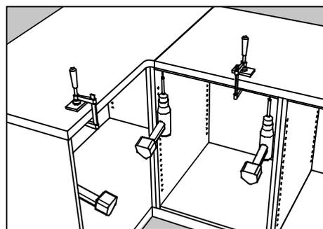
Fixer le plan de travail aux éléments de cuisine en utilisant les orifices prévus pour les vis. Le plan de travail peut éventuellement être maintenu par des serre-joints sous la fixation ; ne pas oublier de mettre des plots de protection pour éviter d'endommager la surface.
