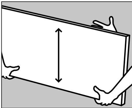
Les plans de travail doivent être installés dans les 8 jours suivant la réception. Jusque là, ils doivent être conservés dans leur emballage de transport. Les plateaux doivent être acclimatés au minimum 24 heures avant leur installation. Le local doit être chauffé à 20 degrés et l'humidité de l'air doit être d'env. 50%.
