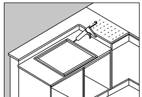
Pour placer/montar les plaques de cuisson intégrées à la surface plane, il est nécessaire de sceller tout le pourtour de la plaque de cuisson. S'assurer qu'il y ait assez de mastic d'étanchéité pour lisser celui-ci uniformément tout autour. Le mastic peut être commandé avec la plaque de cuisson.
