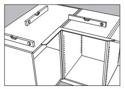
Avant le montage, vérifiez avec un niveau que les éléments de cuisine montés sont installés à l'horizon-tale et à angle droit, les uns par rapport aux autres. La moindre différence de niveau peut rendre l'assemblage difficile. Il est possible de rectifier le niveau avec une mince feuille de placage ou autre matériau similaire.
