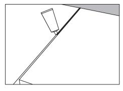
Mettez ensuite du matériau de scellement (le mastic mince joint et non du silicone ou de la colle à bois) dans le joint, de manière à obtenir le scellement du panneau d'aggloméré brut. Le scellement est surtout important sur la partie supérieure du panneau d'aggloméré brut la plus proche de la surface du stratifié. La pénétration d'eau dans les joints n'est pas couverte par la garantie.
