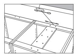
Pour le montage du plan sur des éléments sans dessus, le joint doit être soutenu sur toute la longueur avec un panneau plat (aggloméré, contreplaqué ou autre). Fixez l'attache de serrage par l'intérieur du placard.
