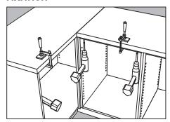
Fixez le plan de travail aux éléments de cuisine à l'aide des trous prépercés. Nous conseillons un trou tous les 60 cm dans le bord avant et dans le bord arrière. Fixez toujours les extrémités du plan de travail. Vous pouvez éventuellement maintenir en place le plan de travail avec des serre-joints, pendant la fixation mais n'oubliez pas de mettre des blocs de protection pour éviter d'endommager le revêtement en stratifié.
