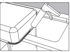
Mettez du matériau de scellement dans le rebord de l'évier avant de le mettre en place et de le fixer. Pour le montage d'un robinet mitigeur, percez les orifices nécessaires pour les tuyaux. Mettez aussi du matériau de scellement. Tous les perçages dans le stratifié doivent être scellés.
