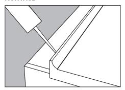
Déposez les plans de travail sur les éléments, pour la fixation finale. Si le plan de travail est livré avec un bord arrière fixé, appliquez le matériau de scellement entre le bord arrière et le mur. En cas de maçonnerie humide, scellez tout le dos du bord arrière.
