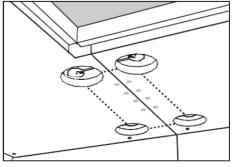
Ajustez les attaches de serrage, en alternance. Lors du serrage des plans de travail, assurez-vous que les surfaces sont alignées. Lors du serrage, l'excédant de matériau de scellement sortira par le haut, si l'assemblage correct.
