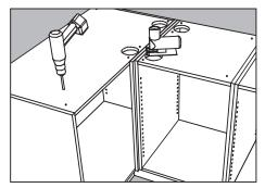
Si les placards ont un dessus, découpez un orifice sur le dessus pour que le serrage des joints éventuels du plan de travail avec des attaches de serrage puisse se faire par l'intérieur du placard. Si les trous de vis ne sont pas percés en usine, percez des trous, tous les 60 cm. Les plateaux de table doivent être soutenus tous les 600 mm.
