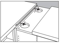
Au niveau des joints, ajustez la longueur de la barre métallique jointe avant de la fixer dans la rainure. N'assemblez pas complètement les plans et fixez les attaches d'assemblage.
