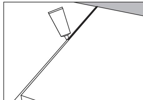
A continuación rellene las juntas con el material de sellado que se suministra (no utilice silicona ni cola de carpintero), de forma que quede sellado el tablero de conglomerado sin tratar. El sellado es especialmente importante en la parte superior del tablero más próximo a la superficie de laminado. La garantía no cubre los daños producidos por filtraciones de agua en las juntas.
