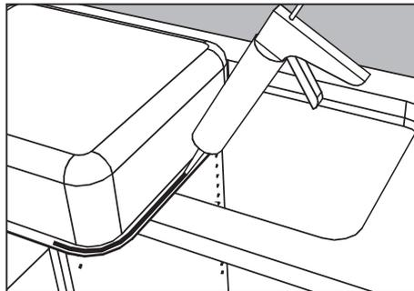
Cubra el contorno del fregadero con material de sellado antes de colocarlo y sujetarlo. Para colocar los grifos mezcladores, perforo los orificios necesarios para que pasen los tubos. Estos orificios deben sellarse también con material de sellado ya que todas las entradas que se realicen en el laminado deben quedar selladas.
