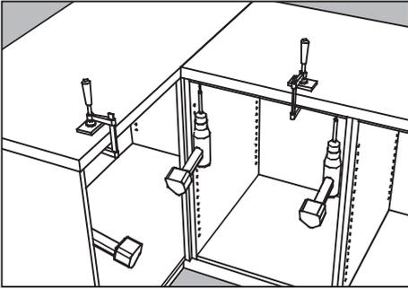
Fije la encimera a los módulos de cocina utilizando los agujeros previamente perforados. Recomendamos colocar un tornillo en el canto frontal y otro en el trasero cada 60 cm. Los extremos de la encimera deben fijarse siempre. La encimera puede sujetarse con mordazas durante el montaje; en ese caso, utilice protectores para evitar que se estropee la superficie de laminado.
