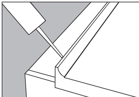
Coloque la encimera sobre los módulos para su sujeción definitiva. Si la encimera se entrega con el canto trasero ya colocado, debe aplicarse material de sellado entre el canto y la pared. En paredes con humedad, selle toda la parte posterior del canto trasero.
