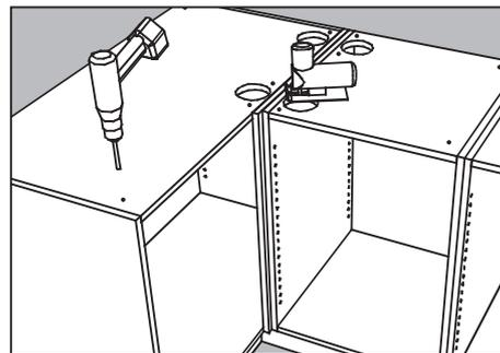
Si los armarios están cubiertos, debe realizarse un orificio en la parte superior para, en caso necesario, poder acoplar las juntas de la encimera con un herraje desde el interior del armario.
