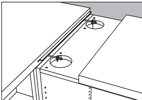
Ajuste la longitud de la lengüeta suministrada con el producto antes de colocarla en la ranura de la junta. No junte totalmente los tableros y coloque el herraje de unión.
