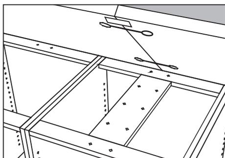
Cuando se montan encimeras sobre módulos sin cubrir, toda la superficie de las juntas deberá apoyarse sobre un tablero plano (de conglomerado, chapado o material similar). Coloque los herrajes de sujeción desde el interior del armario. Coloque la pletina en la parte inferior de la encimera bajo la junta del canto frontal, para que la junta no se raye en dicho canto. Nota: Todas las juntas deben estar apoyadas y sujetas con tornillos en ambos lados.
