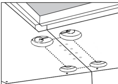
Apriete los herrajes de sujeción de modo alternativo. Durante el acoplamiento de los tableros, es necesario asegurarse de que las superficies estén al mismo nivel. Si la unión se realiza correctamente, el material de sellado sobrante saldrá hacia fuera.
