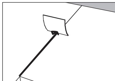
Espere unos 5 minutos y retire el material de sellado sobrante con un trozo de cartón, siempre desde el canto trasero hacia el canto frontal. Arrastre siempre el cartón hacia usted, de forma que el material sobrante penetre en lugar de salir. Los posibles restos de material de sellado pueden eliminarse con agua jabonosa.
