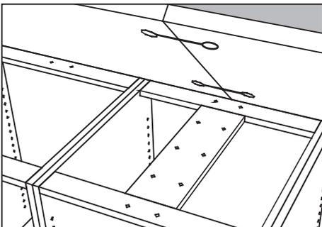
Par montage de plaque sur des éléments en dehors de la page doit être appuyé l'assemblage sur toute la longueur du plan de la plaque (par exemple panneaux de particules, contre-plaqué ou similaire). Avis important: Tout assemblage devrait toujours soutenu et monté avec des vis en paires.
