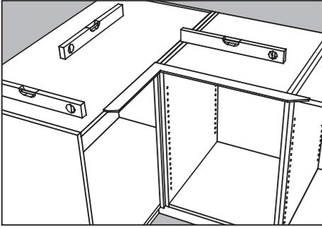
Avant l'installation, vous devez par un niveau à bulle d'air que les éléments de cuisine vérifier que l'ensemble monté horizontalement et dans l'angle les uns des autres. Existe-t-il moins niveau différences, mai il être difficile d'obtenir une collecte pour s'adapter. Cela peut être résolu par une mince feuille de placage ou d'autres matériaux similaires.
