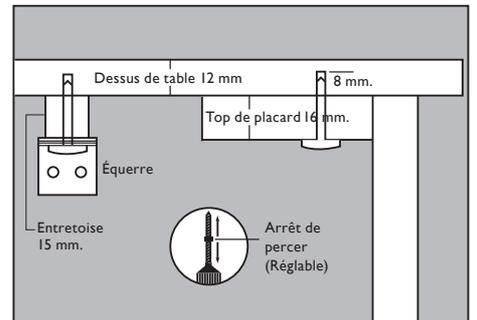
Le kit de service fourni pour la plaque stratifiée compacte contient les vis et équerres nécessaires ainsi qu'une mèche de 3 mm avec butée réglable. Percer 8 mm. vers le haut dans le plan de travail. Pour les armoires sans haut, utiliser les équerres et les entretoises fournies.
