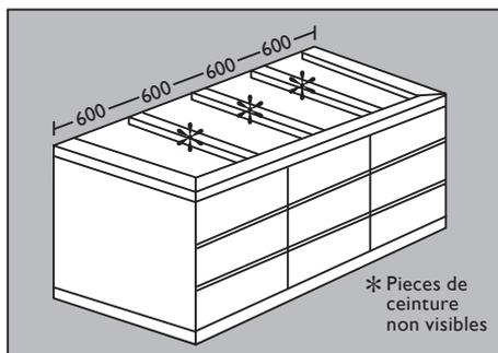
Pieces de ceinture, qui ne sont pas visibles, ne possède pas un avantage, et doit être réglé par l'installateur. Distance maximale entre ces pieces de ceinture est 600 mm.
