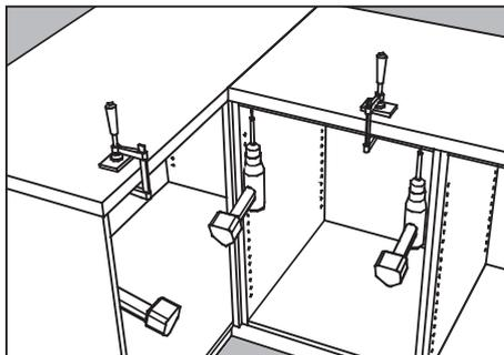
Le dessus de table est assemblée à les éléments de cuisine à travers la vis avant-trous. Le dessus de table est peut-être maintenu avec des pinces au cours de fixations, mais rappelez-vous morceaux de protection pour éviter les dommages à la surface.
