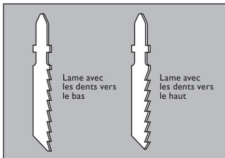
Sciage de l'avant avec une hausse lame peut provoquer des déchirures dans la surface.
