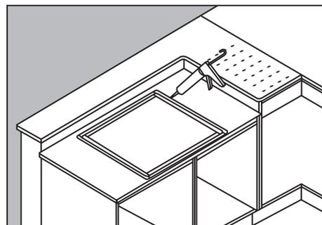
Pour l'installation de plaques chauffante, qui sont intégrés dans le plan, qui autour de la jointure du plaque chauffante. Assurez-vous qu'il suffit d'étanchéité, de sorte que la jointure peut satiner assez uniformément tout autour du plaque chauffante. D'étanchéité pour joints peuvent être commandés avec la plaque chauffante. Lorsque les plaques de cuisson sont collées à plat, la plaque de cuisson doit être surélevée de sorte qu'elle soit placée juste au-dessous du niveau du plateau de table.
