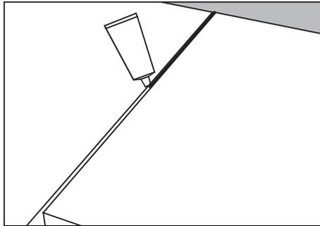
Les matériaux de scellement, à prendre en compte le pâte d'étanchéité resserré (pas de silicone ou du colle à bois) et ensuite à l'assemblage, pour permettre d'optimiser l'étanchéité. Il n'y aura pas de garantie en rapport avec l'eau dans les assemblages. D'après, les plans se repousse ensemble.
